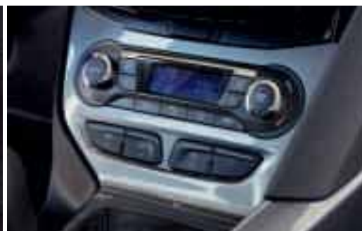
Klímaberendezés kétfónás elektronikus automatikus hőmérséklet-szabályozással (DEATC) (Alapfelszereltség)
